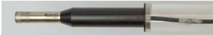
(d) Seating the preamplifier
