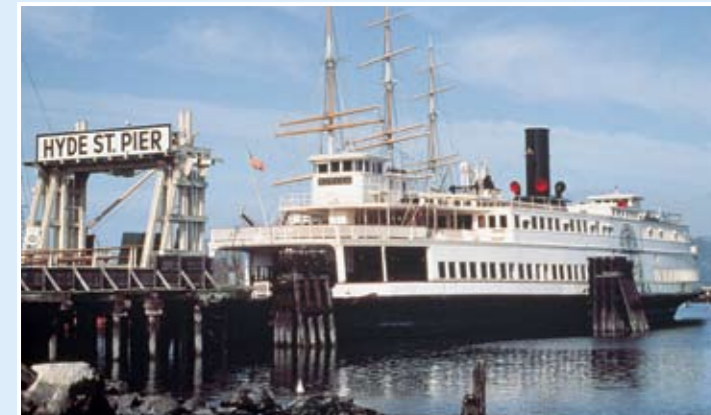
L'Eureka: Navire à roue latérale de 91 mètres (299,5 pieds). Construit à l'origine en 1890, et baptisé sous le nom d' Ukiah , à Tiburon, en Californie ; ensuite rénové en 1922, et rebaptisé sous le nom d' Eureka .
