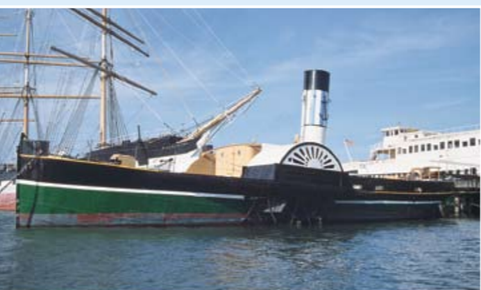
エップルトン・ホール号：鋼鉄製タグボート；100.5フィート。1914年、英国、サウスシールドにて建造。
